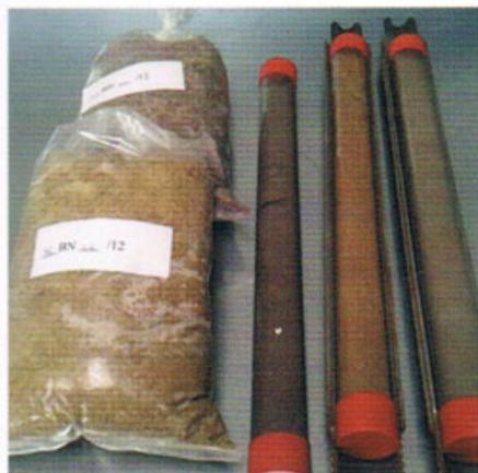
Prélèvement d'un échantillon sur le terrain
