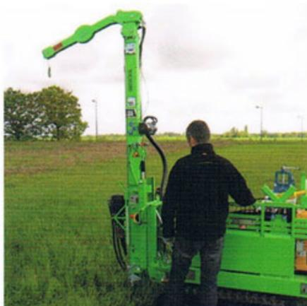
Sondages menés par nos géotechniciens avec relevés des données mécaniques du sol
